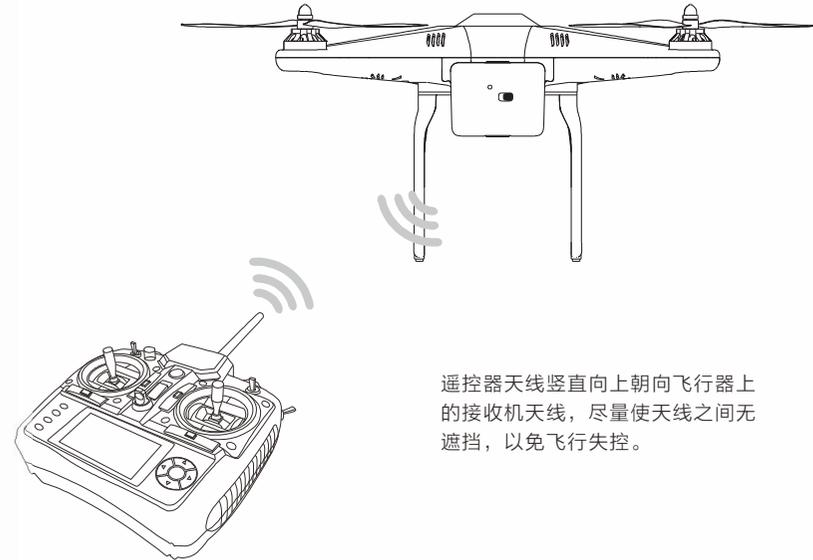
遥控器天线竖直向上朝向飞行器上的接收机天线，尽量使天线之间无遮挡，以免飞行失控。
